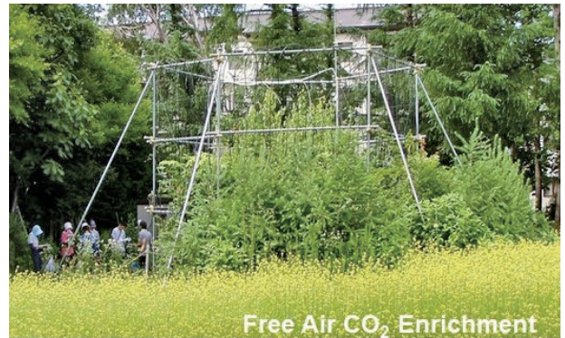
図5 北海道大学・北方生物圏フィールド科学センターの開放系CO 2 付加(FACE)施設(高さ5m;直径6.5m) 現在は、オゾン付加施設に改修した。
